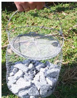
Figura 3: Cesto com substrato artificial utilizado na coleta dos organismos
