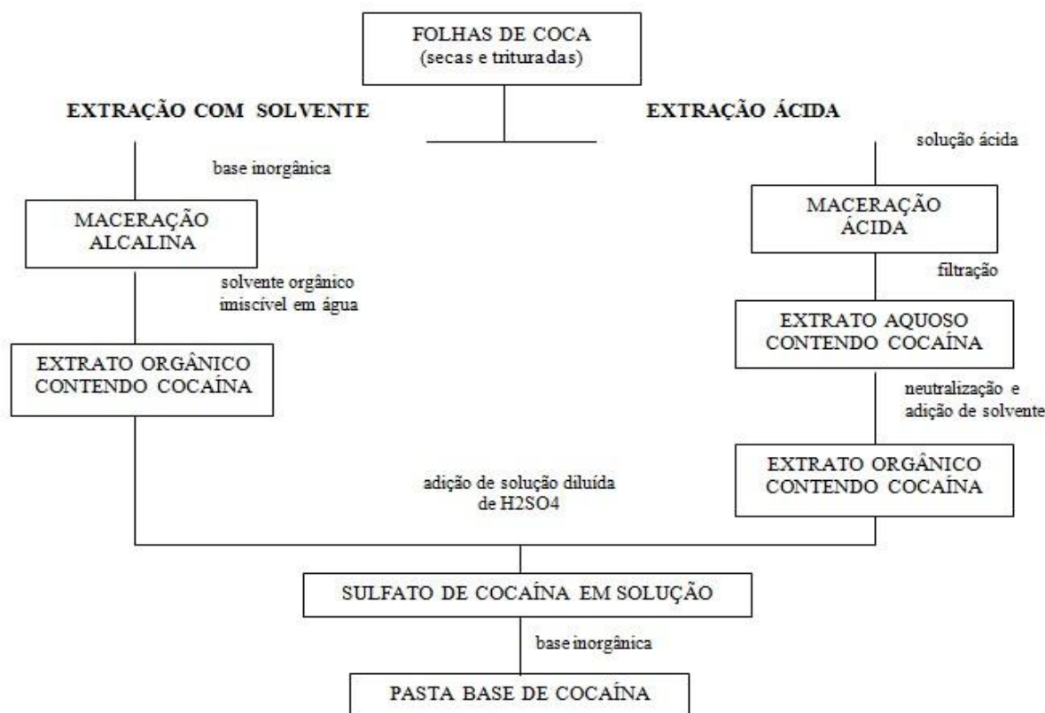
Figura 1: Fluxograma das etapas de produção da pasta base de cocaína. Fonte: CASALE e KLEIN, 1993.
